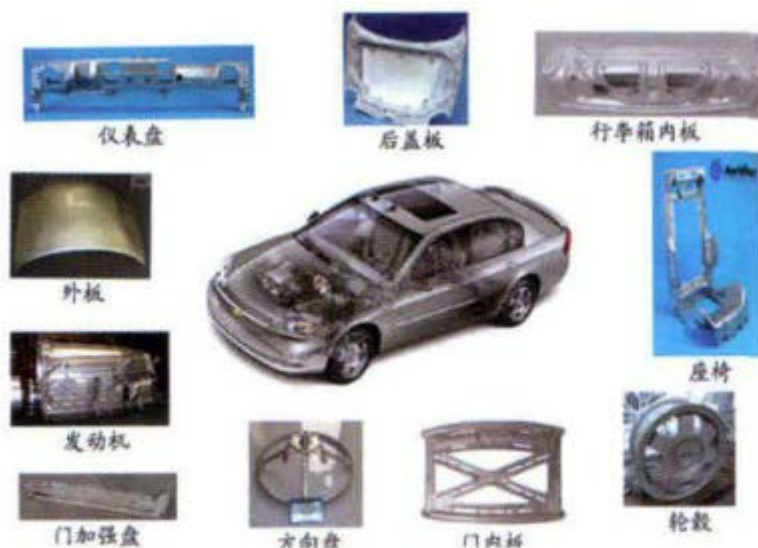
在轿车上可能或已在部分车型上采用的镁合金的部件。陕镁V言
