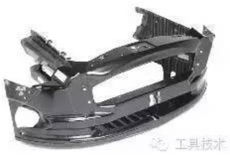
图 4 阿斯顿·马丁 Vanquish 跑车的前部缓冲结构主要采用碳纤维复合材料制成
