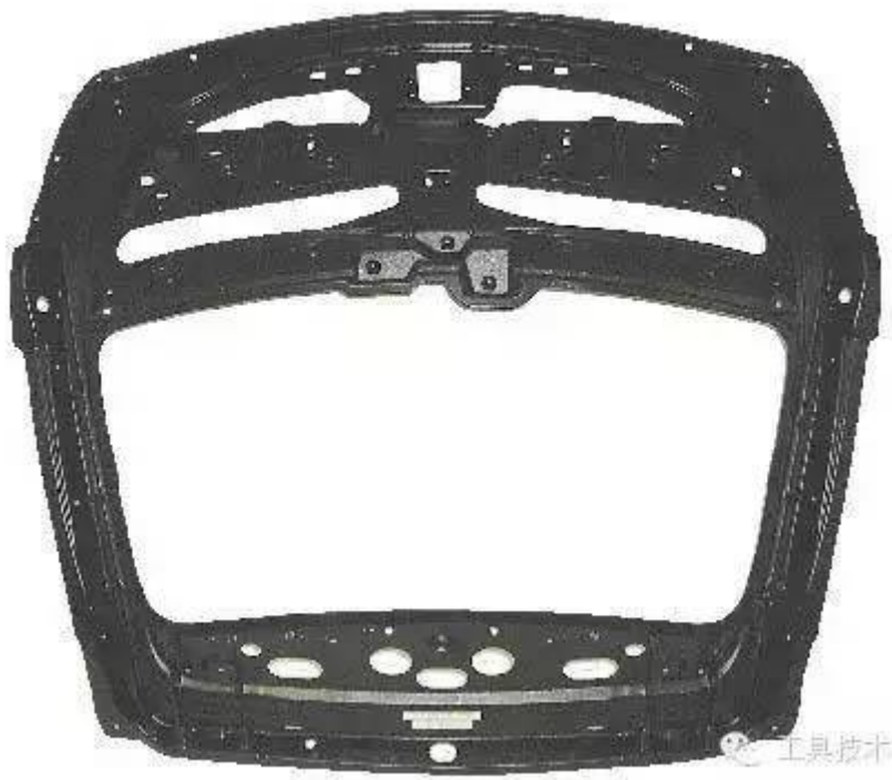
图 2 林肯 MKT 多用途 SUV 掀背式铸镁车门框的重量比相同的冲压钢门框轻 40%
